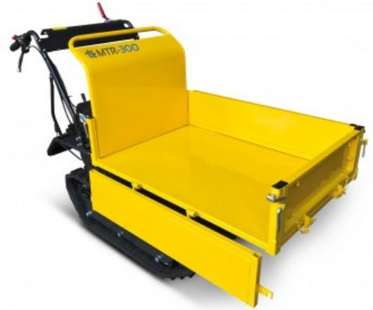
Der **BAMATO Mini Transporter MTR-300** ist ein echtes Multitalent. Mit einer **Bodenfreiheit von 110 mm** leistet als Transporthelfer wertvolle Dienste selbst in engem und unwegsamem Gelände.
