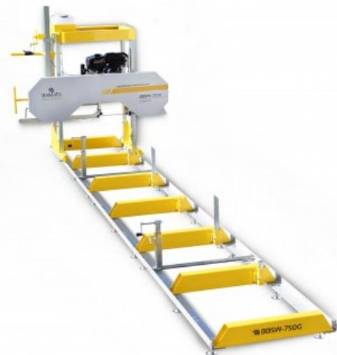
Die neue **BAMATO Blockbandsäge BBSW-750G** ist ein echtes Kraftpaket. Der Antrieb erfolgt über einen 9,0 kW Benzinmotor mit Elektrostart. Ausgewuchtete und robuste Antriebsräder aus Grauguss sorgen für ein perfektes Schnittergebnis. Diese Maschine ist ideal für präzises Sägen von weichen, harten und trockenen Hölzern.
