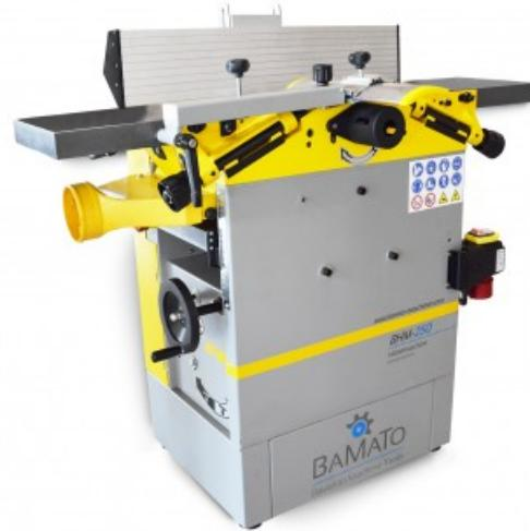
Die **BAMATO Abricht- und Dickenhobelmaschine BHM-250** für den ambitionierten Heimwerker ist mit einer präzisionsgelagerten Messerwelle ausgestattet, welche mit 3 Stück HSS-Hobelmessern bestückt ist. Durch die **Hobelbreite bis zu 250mm und einem Dickendurchlass von 185mm** ist die Hobelmaschine ideal zum Hobeln von Leisten, Kanthölzern und Brettern geeignet. Der stabile und verwindungsfreie Abrichttisch aus Grauguss sorgt für ein perfektes Hobelergebnis beim Abrichten.
