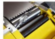
Die **BAMATO Abricht- und Dickenhobelmaschine der PRO-Serie** für den professionellen Heimwerker ist mit **einer Spiralmesserwelle ausgestattet, welche mit 24 Hartmetall Wendeplatten** bestückt ist. Durch die spiralförmige Anordnung der HM-Wendeplatten entsteht ein sogenannter **ziehender Schnitt** mit einem perfekten Hobelergebnis. Außerdem wird hierdurch die **Lärmbelastung um bis zu 50% minimiert**. Ein weiteres Highlight ist der stabile und verwindungsfreie Abrichttisch aus Grauguss.
